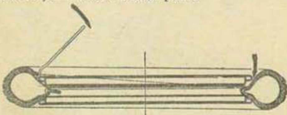
18. Rez ráfikom a pneumatikou — montáž pneumatiky
